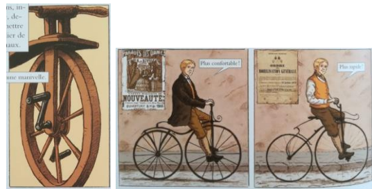
A gauche : fixation de pédales sur la roue avant de la draisienne A droite : évolutions de la Michaudine
