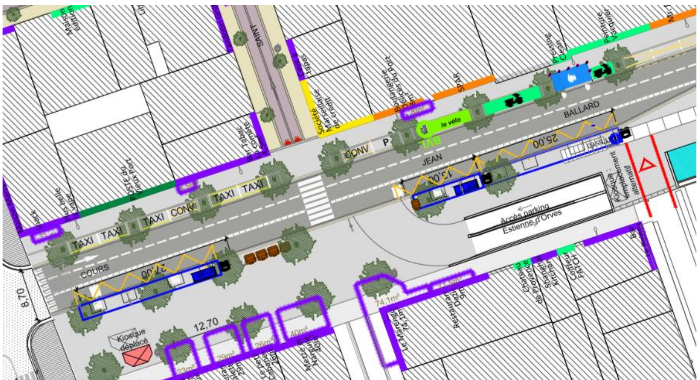
Figure 17 Aménagements des quais bus du Cours Ballard
