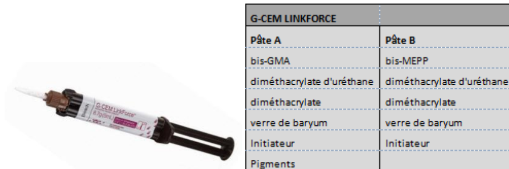
Figure 15 : Conditionnement en seringue auto-mélangeante de la colle composite duale universelle G-CEM LinkForce® de la société GC, utilisée après les étapes de mordantage acide et de séchage de la vitrocéramique IPS e.max® Press (Ivoclar-Vivadent) suivi par l'étape de dépôt d'une goutte de silane MPS (Ultradent). Le tableau de droite sur la figure, liste les composants présents dans chacune des pâtes qui seront mélangées dans l'embout. Ces données sont issues de la notice fournie par le fabricant GC.
