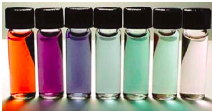
Figure 13 : Démonstration visuelle du « réglage » des propriétés de nanoparticules métalliques. L'exemple ci-dessus est celui de nanoparticules composées d'un cœur de silice recouvert d'une enveloppe d'or, dont les propriétés d'absorption optiques changent en fonction de la taille du cœur et de l'épaisseur de l'enveloppe d'or. Figure issue de la référence 80 .
