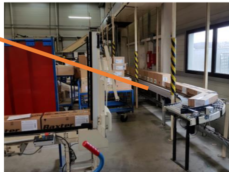
Figure 27 : convoyeur des colis standards à destination de la table à bille
