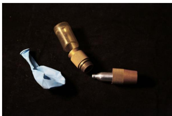
Figure 6 : Cartouche, cracker et ballon de baudruche
