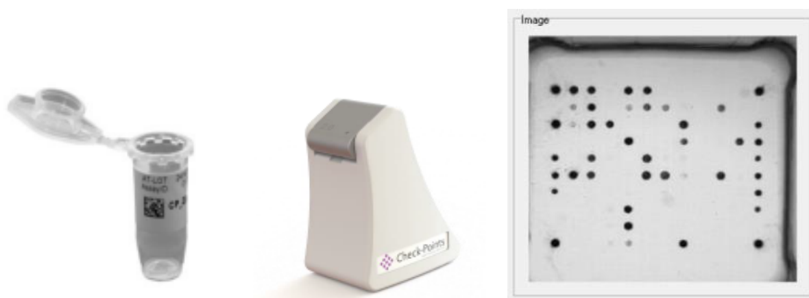
Figure 24 - Puce à ADN et dispositif de lecture de la puce (d'après le manuel d'utilisation Check-MDR CT103XL) (140)
