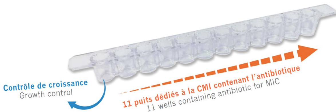
Figure 19 - Aspect d'une cupule de CMI liquide (d'après la notice fournisseur : https://www.biocentric.com/umic )
