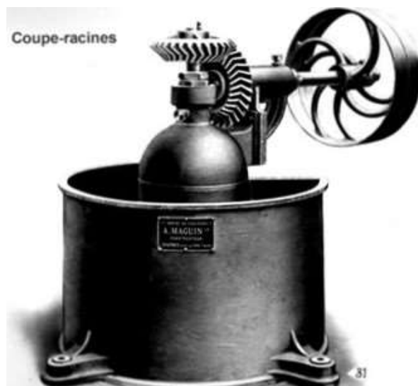
Fig. 19 : Représentation d'un coupe-racine, fin XIX e siècle. Photo ASSF-2011
