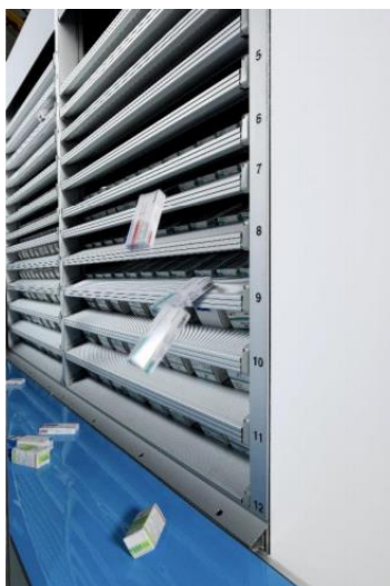
Figure 28 : Système d'éjection (Automate Apoteka)
