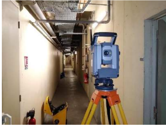
Figure 3 : Lever du couloir avec le tachéomètre
