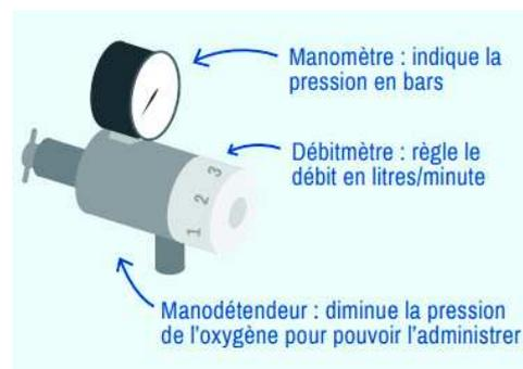
**Figure 5 : Représentation d'un manodétendeur**
