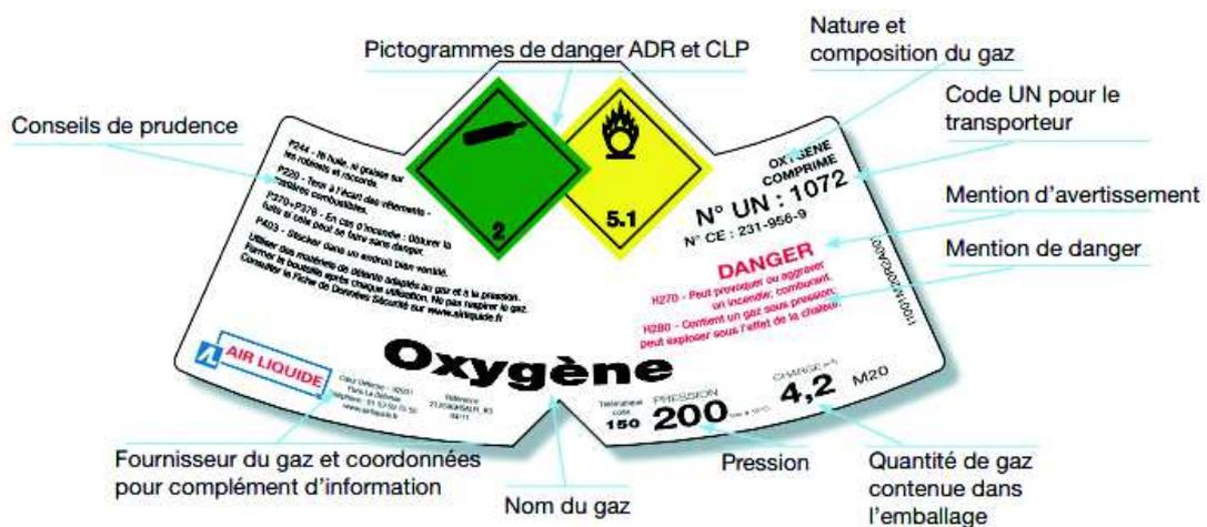
**Figure 4 :** Exemple d'une étiquette d'une bouteille d'oxygène<sup>vii</sup>
