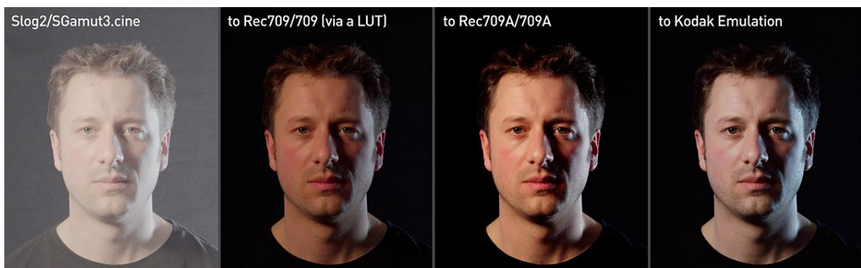
Différents types de LUTs utilisées à partir d'une image encodée en S-log2
