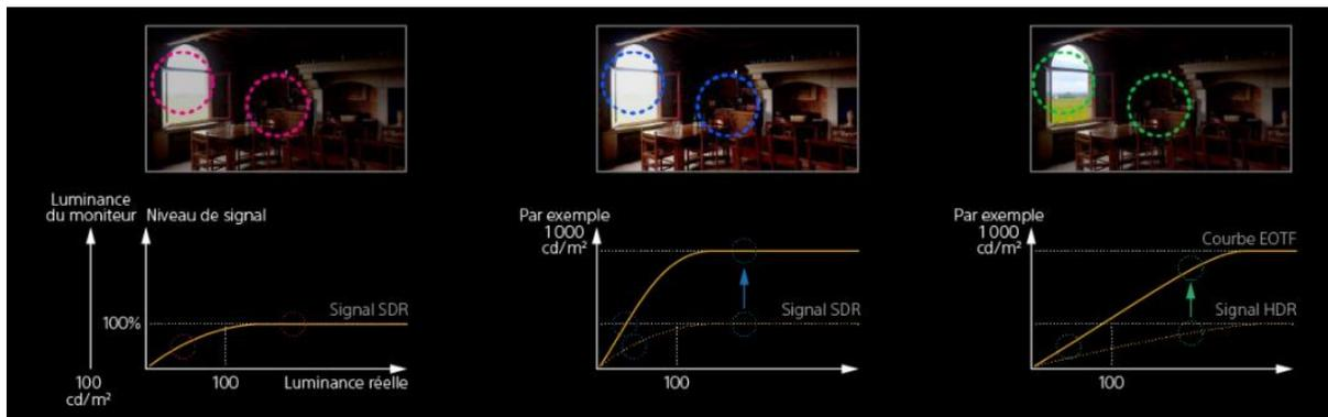
Schéma extrait du site d'un article de TRM (<https://www.trm.fr/blog/production-hdr-des-images-plus-vraies-que-nature-avec-sony/>). La reproduction HDR nous montre que les niveaux de luminosité reproduits par rapport au signal SDR, n'écrêtent pas les highlights de l'image et ne compressent pas les shadows pour gagner en informations ainsi qu'en dynamique visuelle
