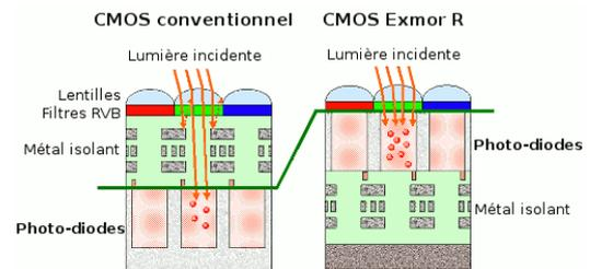
*Différence Capteur CMOS et CMOS EXMOR*
