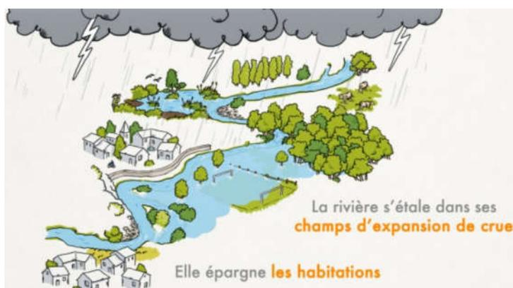
Figure 4 : Schéma d'une zone d'expansion de crue. (Source : Pour une nouvelle gestion des rivières, Agence de l'Eau Rhône Méditerranée Corse.)
