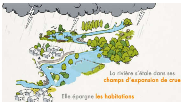
Figure 4 : Schéma d'une zone d'expansion de crue. (Source : Pour une nouvelle gestion des rivières, Agence de l'Eau Rhône Méditerranée Corse.)
