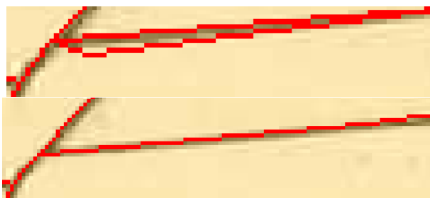
Figure 12 : Exemple de fusion nécessaire pour simplifier les segments en double
