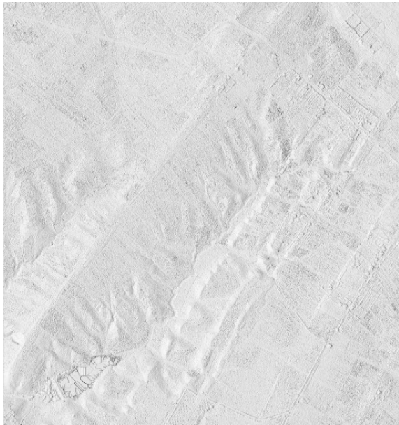
Figure 14 : image d'ombrage du MNS calculé à partir des images Pléiades et résolue à 50 cm
