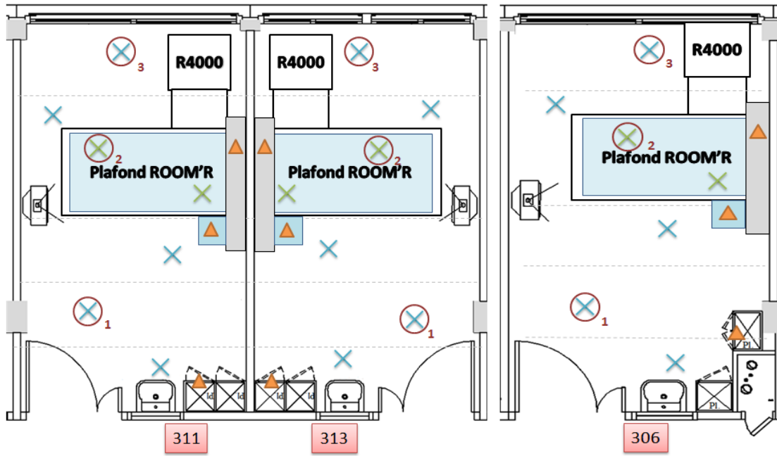
Figure 17 : Plan de prélèvement des chambres équipées de ROOM'R
