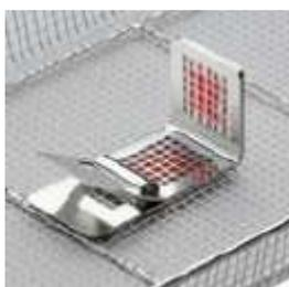
Figure 14 : Position des tests STF<sup>®</sup> dans le panier de lavage
