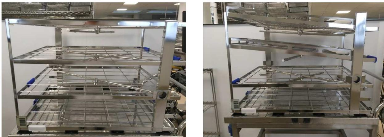
Figure 12 : Embase standard de 4 niveaux et Embase de Cœlioscopie
