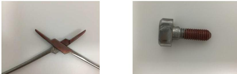
Figure 10 : Instruments badigeonnés au Soil test®
