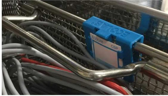
Figure 37: Indicateur ECOLAB® dans un panier de lavage
