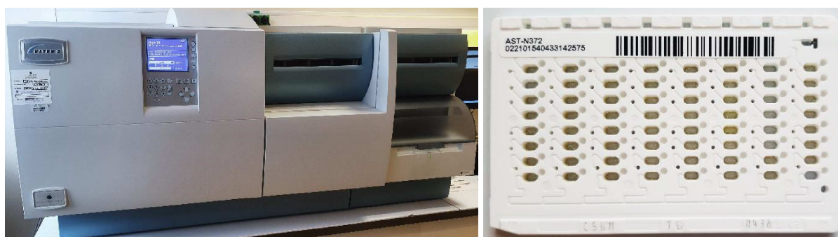
Figure 7: L'automate VITEK ® 2-XL et une carte de test de sensibilité (photographies personnelles)
