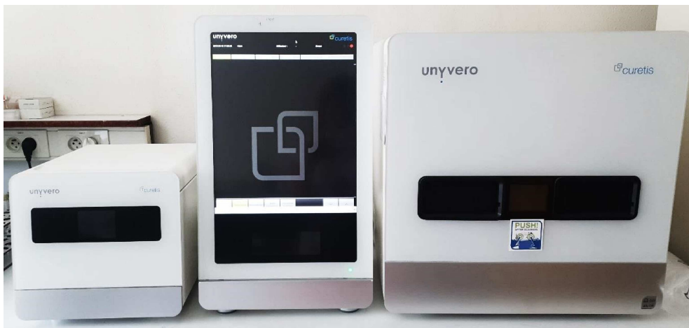
Figure 8 : Présentation du système Unyvero. De gauche à droite : le Lysator, le Cockpit et l'Analyzer (photographie personnelle)
