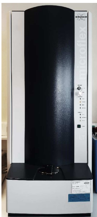
Figure 6: Exemple de système MALDI-TOF au laboratoire du CHU de Caen (Microflex ® , Bruker-Daltonics, Allemagne) (photographie personnelle)
