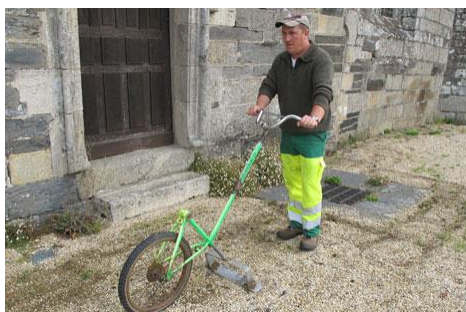
Figure 2 : Le « pousse-pousse sarcloir », outil de désherbage manuel inventé par les agents à Laniscat (22) (Source : Le lien horticole, 2014)
