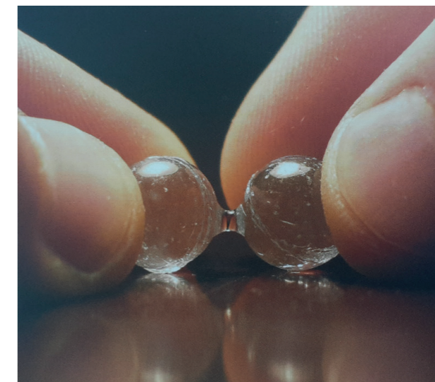
Fig. 10: Les ménisques d'eau entre les plaquettes d'argile créent la cohérence du liant de la terre, source : «Bâtir en terre : du grain de sable à l'architecture»
