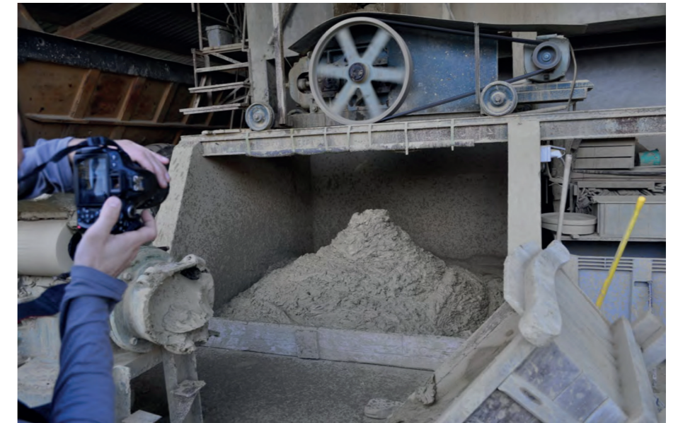
Fig. 20: le laminage de ces terres chez les briquetiers
