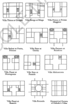
fig. 157 : Grilles d'analyse des villa de Palladio, R. Wittkower, Architectural Principles in the Age of Humanism (1949)
