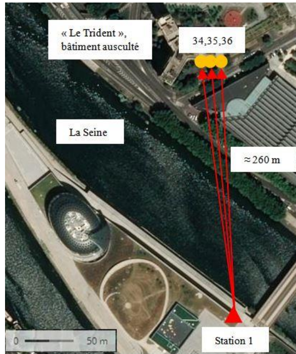
Figure 7 : Emplacements de la station 1 et des prismes 34, 35 et 36
