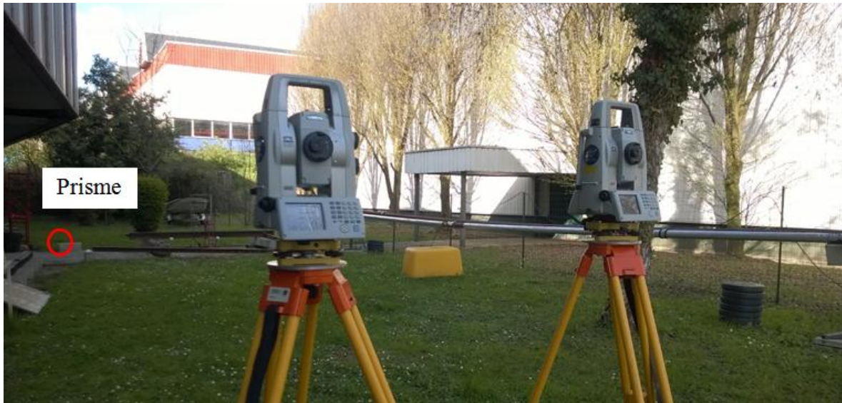
Figure 1 : Mise en place de l'expérience visant à contrôler la précision des ATR
