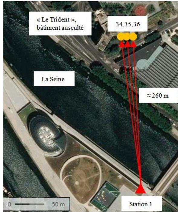
Figure 7 : Emplacements de la station 1 et des prismes 34, 35 et 36
