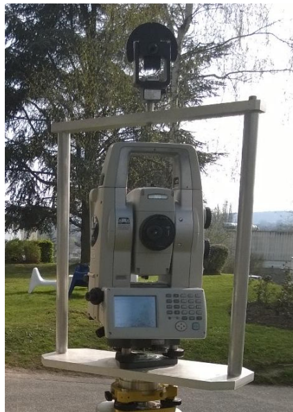
Figure 12 : Montage d'un prisme Leica GMP101 sur une station TOPCON
