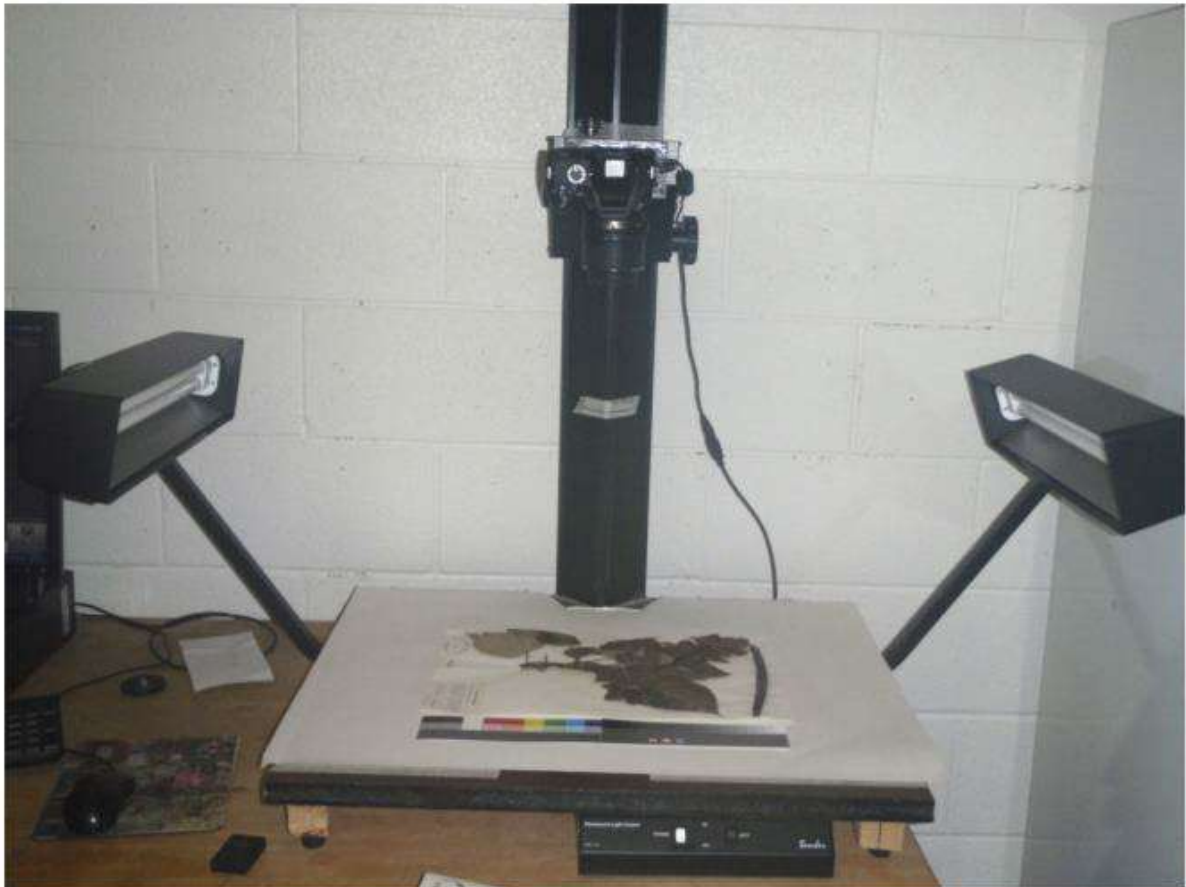
Figure 42 : Dispositif de numérisation composé d'un pied statif à crémaillère, un appareil photo numérique full-frame et un double éclairage latéral. Ce dispositif a été mis en place à l'Arkansas State University (photo) mais aussi au Muséum National d'Histoire Naturelle pour la numérisation des collections d'histoire naturelle. Source : Harris et Marisco, 2017.
