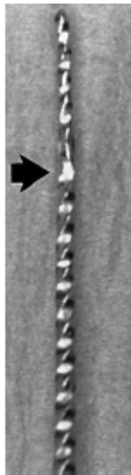
Figure 27 : Distorsion d'une lime
