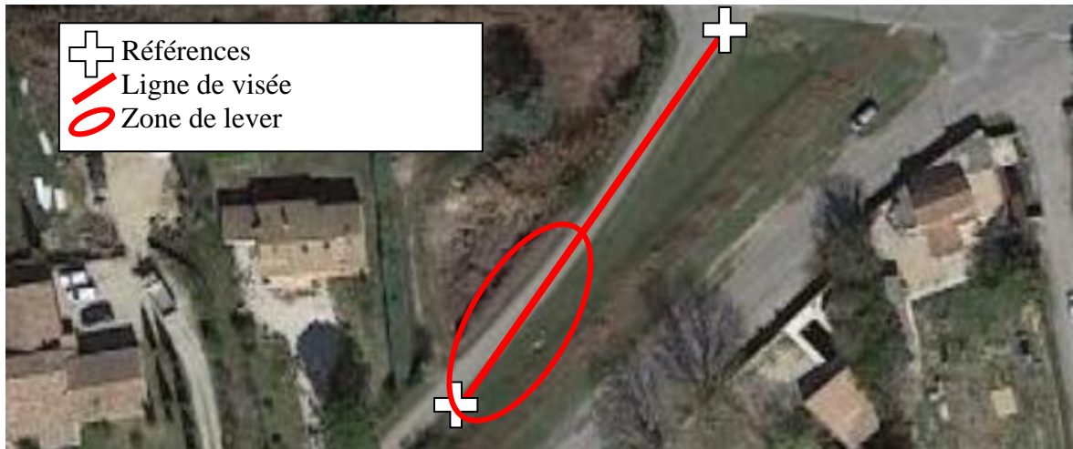
Figure 19 Plan de situation de la zone de levé et schéma des visées de référence
