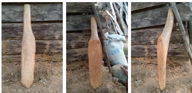
'Pattnem' utilisé par les constructeur-propriétaires dans le village Salgini pour construire leurs propres maisons en pisé.
