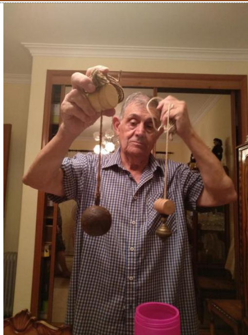
Maçon-Cruiser Joaquim montrant ses fils à plombs des constructions en pisé, datant de 100 ans.
