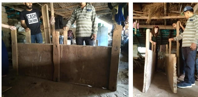
Les parties des banches utilisés récemment à Goa (4 images). [Dessins par Lionel Afonso]
