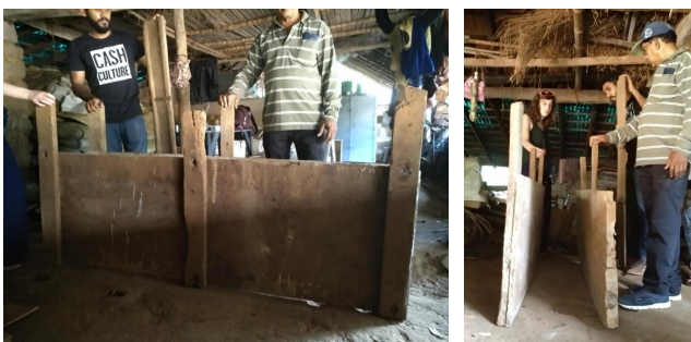
Les parties des banche utilisés récemment à Goa (4 images). [Dessins par Lionel Afonso]
