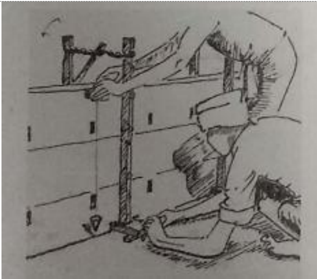
Vérification du niveau par fils à plombs. [Source: Lobo, Earth in Architecture , p.43]
