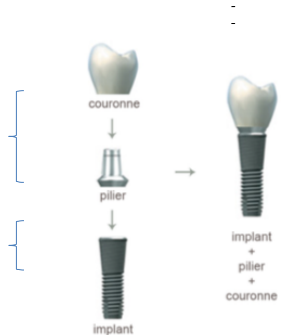
Fig1 : Composition du complexe implantaire
