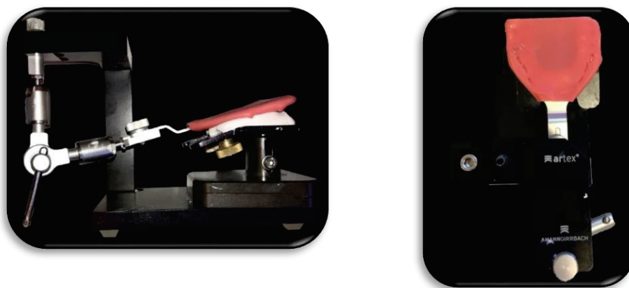
Fig 10. Système de transfert Artex® : système de fixation de la fourchette solidarisé au transfert. Seule la fourchette indentée solidarisée au Snow White et le support du transfert sont transmis au prothésiste.
