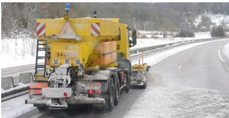
Figure 7 Saleuse : outil de déneigement qui permet de répandre le sel sur la chaussée
