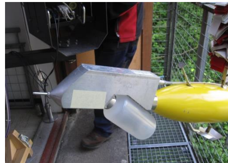
Figure 14 : Préleveur iso-cinétique de l'OFEV déployé lors des chasses du Rhône le 25 mai 2016 à la station hydrométrique de Chancy [HENRY E.]
