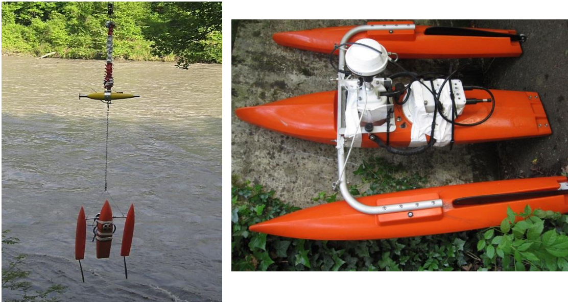
Figure 16 : ADCP déployé lors des chasses du Rhône le 24 mai 2016 à Chancy [Henry E.]
