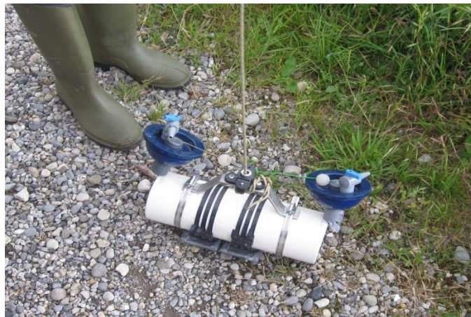
Figure 15 : Préleveur instantané de Van Dorn lors des chasses du Rhône le 24 mai 2016 à Champagneux [HENRY E.]
