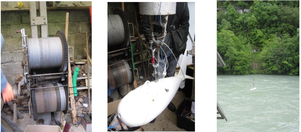
Figure 36 : Les installations sur le site de Bognes (traîle mécanique manuelle, préleveur USGS) [Henry E.]
