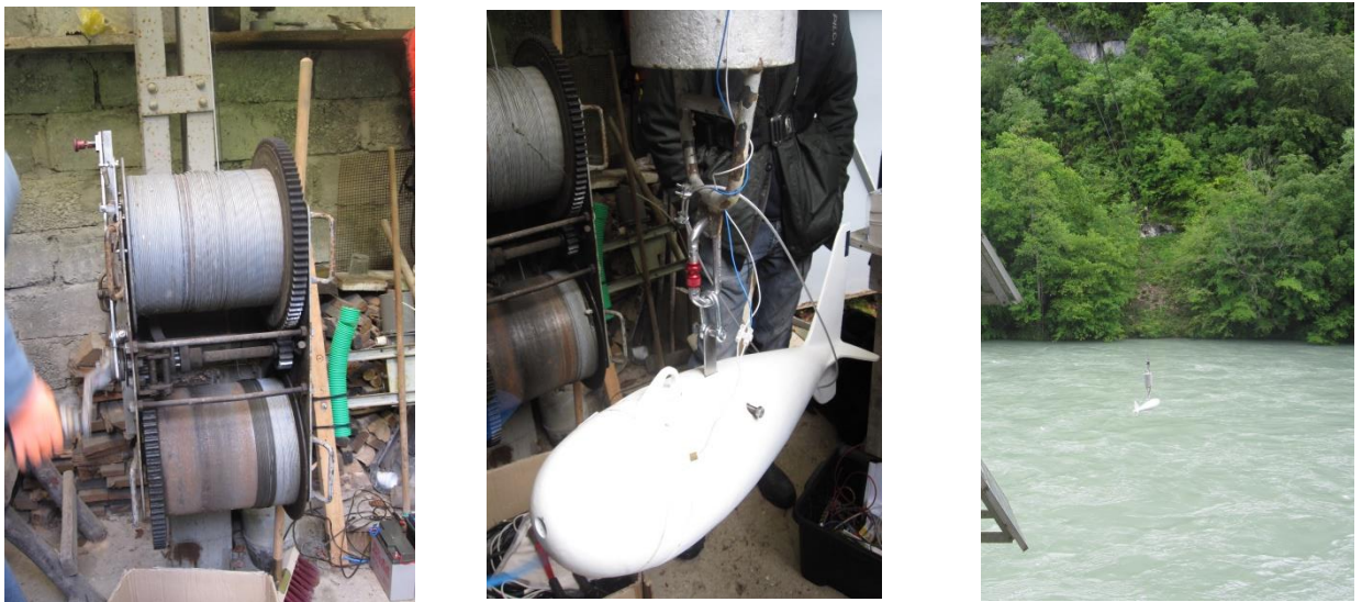
Figure 36 : Les installations sur le site de Bognes (trille mécanique manuelle, préleveur USGS) [Henry E.]
