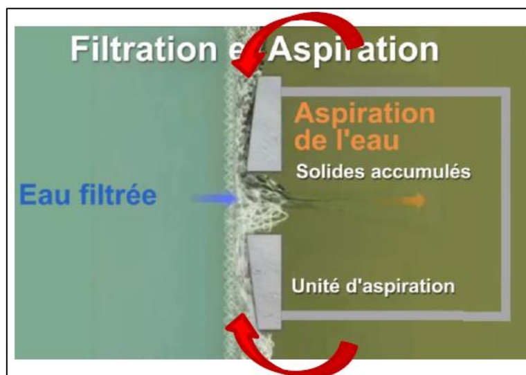
Figure 24 : Schéma du dysfonctionnement du filtre lors des cycles de lavage
