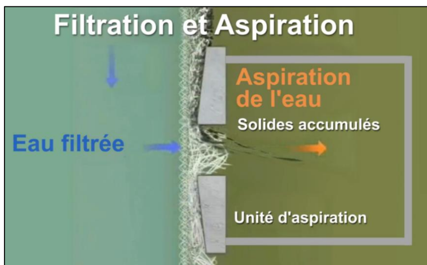
Figure 6 : Schéma du lavage de la toile filtrante (source MECANA)
