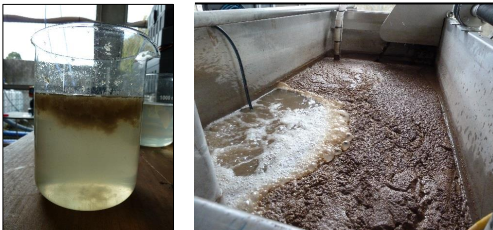
Photo 35 : A gauche, flottation des flocs et à droite accumulation des flocs à la surface du filtre
