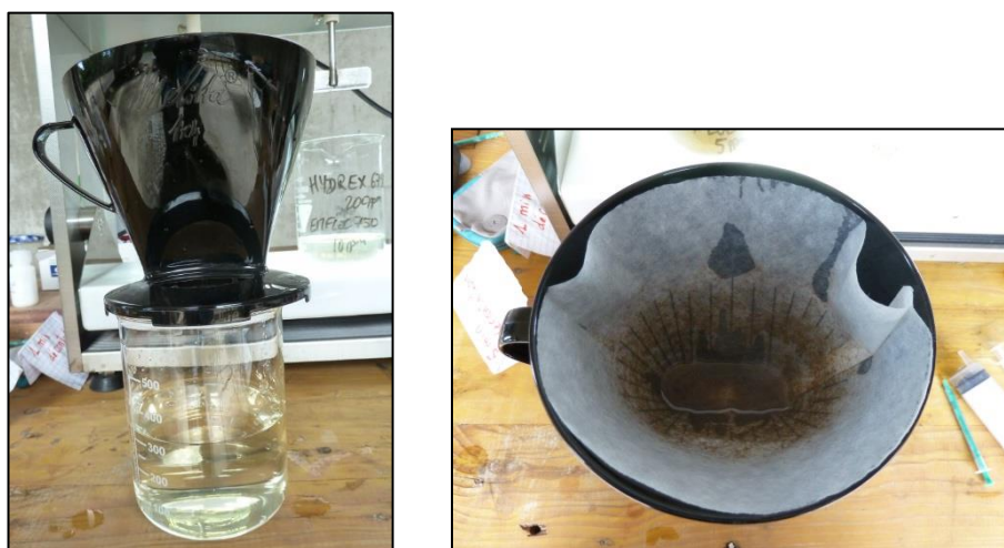
Photo 20 : Filtration sur filtre à café
