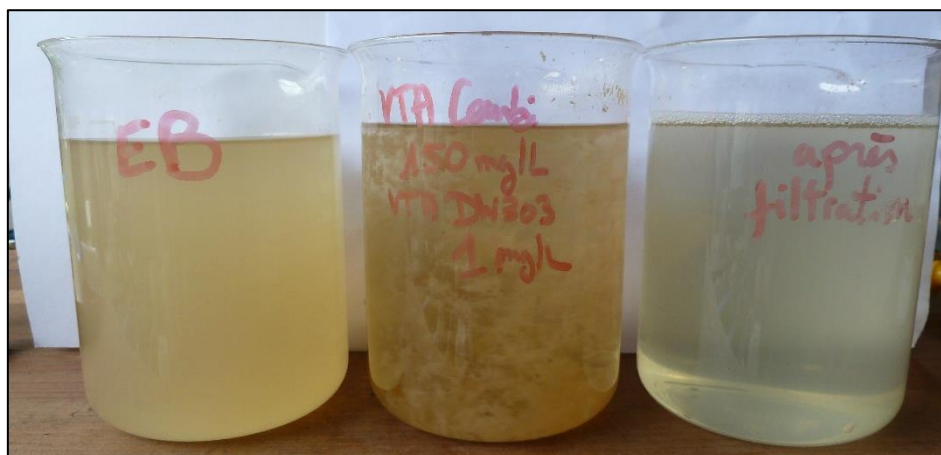
Photo 37 : Effluent brut (g), effluent coagulé-flocculé (milieu), effluent après filtration (d).
