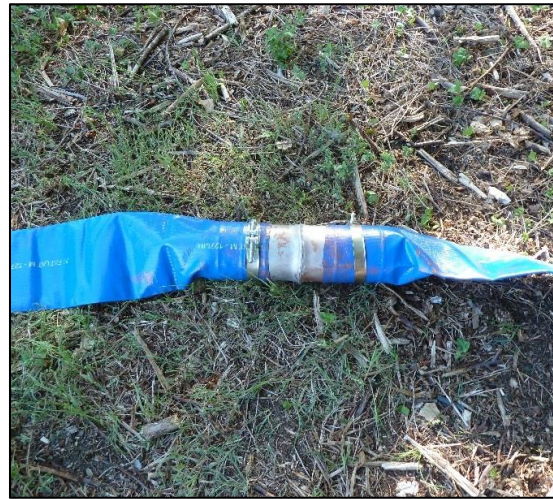
Photo 12 : Dispositif permettant de respecter les temps de contact après la coagulation-floculation
