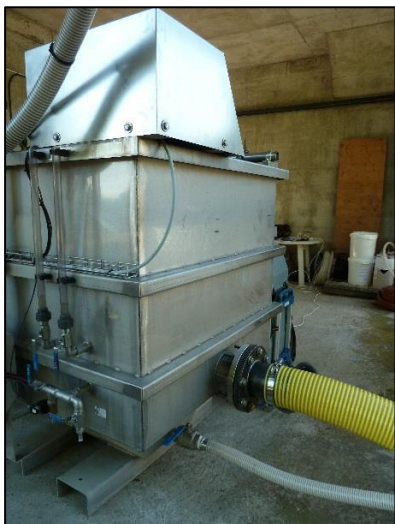
Photo 17 : Sortie du filtre pilote et dispositif de réception des eaux traitées
