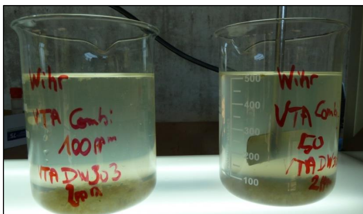
Photo 28 : Jar-tests après l'étape de coagulation-floculation VTA Combifloc-VTA DW303 puis décantation (1min sans agitation) avec des concentrations (mg/L) de coagulant et de floculant respectivement (g.à d.) : 100-2 (Wihr), 50-2 (Wihr).
