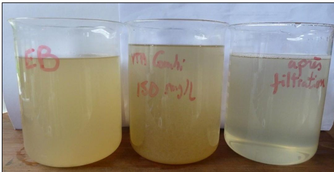
Photo 36 : Effluent brut (g), effluent coagulé (milieu), effluent après filtration (d).
