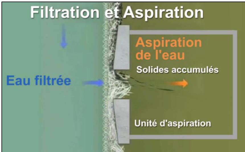
Figure 6 : Schéma du lavage de la toile filtrante (source MECANA)
