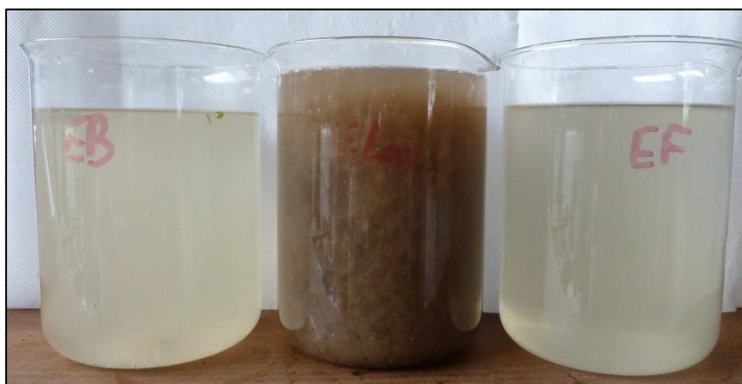
Photo 29 : Effluent brut (g.), eaux de lavage (milieu), effluent après filtration primaire à 5 µm (d.)
