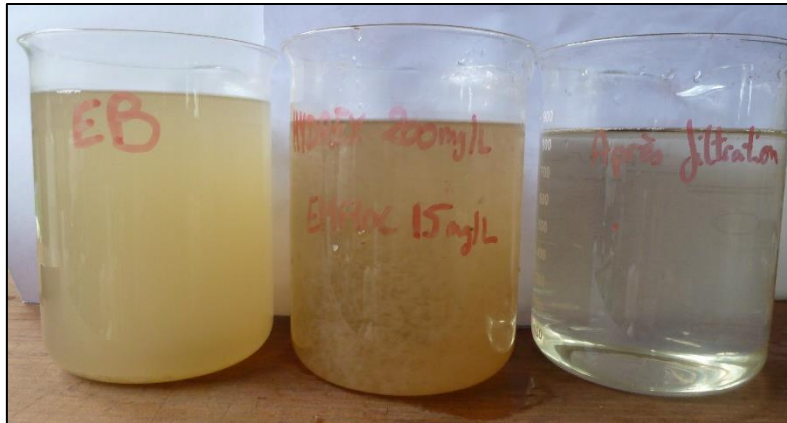
Photo 34 : Effluent brut (g), effluent coagulé (milieu), effluent après filtration (d).
