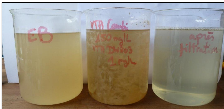
Photo 37 : Effluent brut (g), effluent coagulé-floculé (milieu), effluent après filtration (d).
