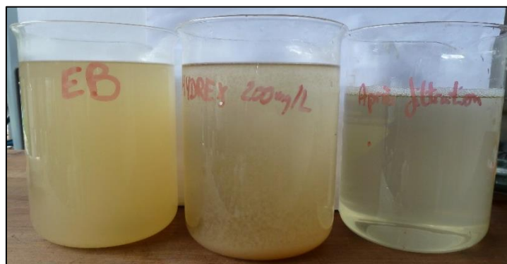
Photo 32 : Effluent brut (g), effluent coagulé (milieu), effluent après filtration (d).
