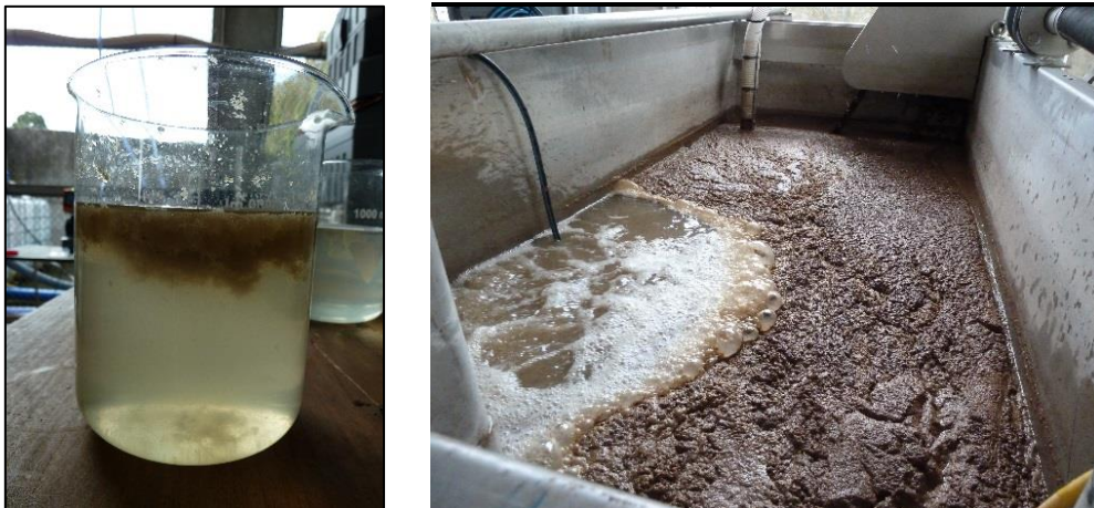
Photo 35 : A gauche, flottation des floccs et à droite accumulation des floccs à la surface du filtre
