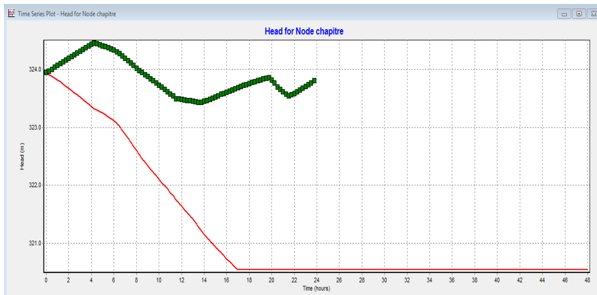
Figure 26: Autonomie critique du réservoir Chapitre
