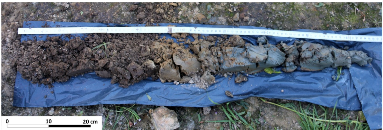
Figure 3.20 : Exemple de carottage suite au sondage à la tarière (R. Létondot, 2019)
