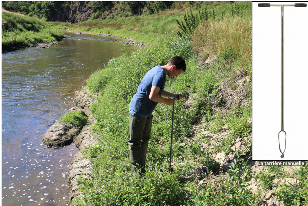
Figure 3.19 : Sondage à la tarière à main sur les berges de la Sélune (R. Létondot, 2019)
