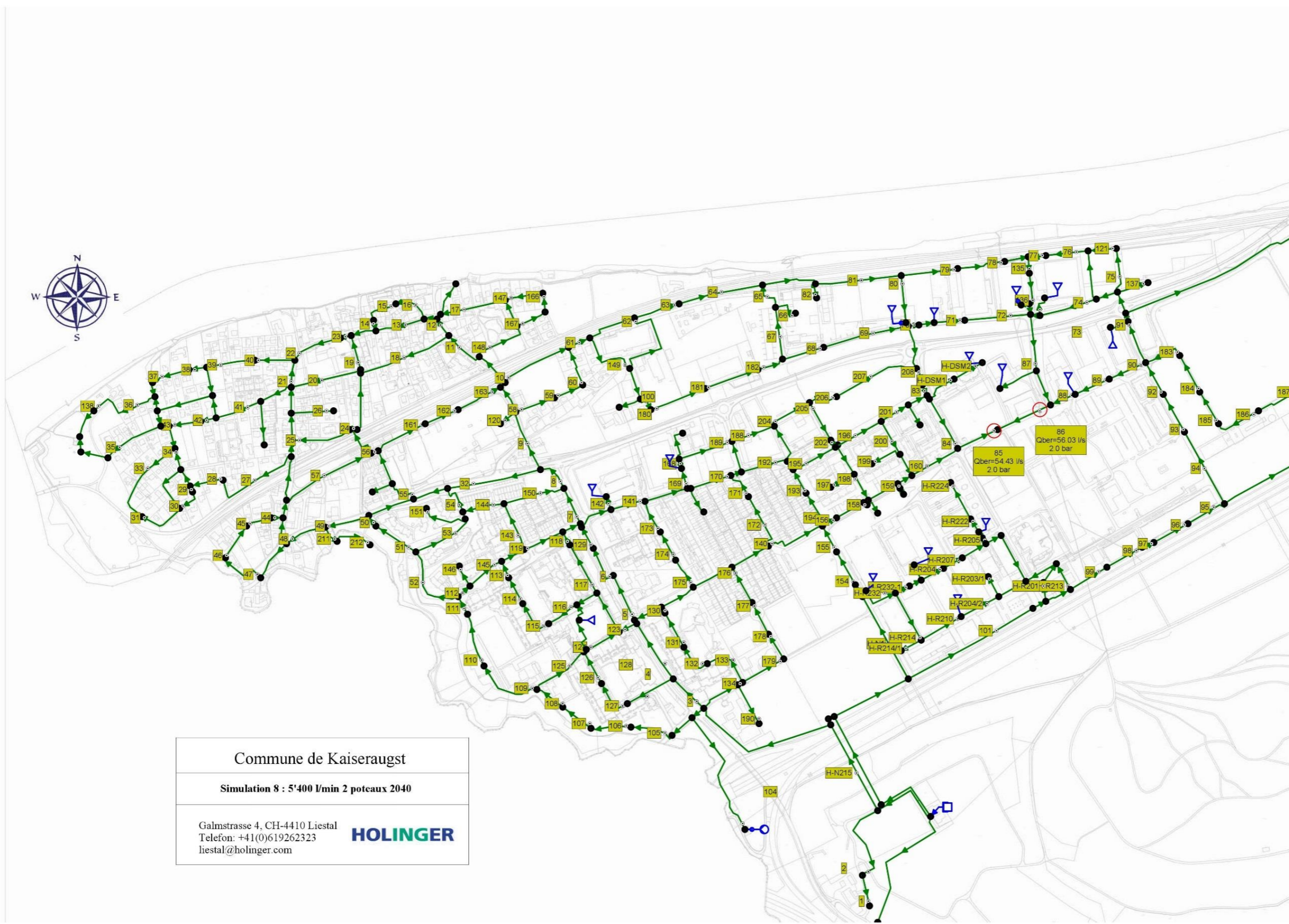
Annexe 20 : Simulation 8 représentation 5'400 l/min extérieur de la zone Roche avec 2 poteaux pour l'état futur
