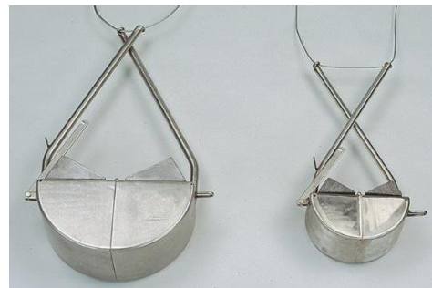
Figure 9 : Bennes à sédiments type Van Veen pour extraction du haut d'un pont - SDEC
