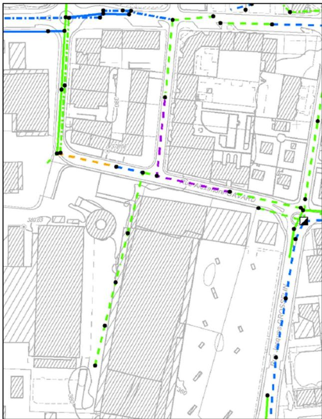
Une partie des collecteurs du secteurs présente une durée de vie réduite à moins de 20 ans, voir à moins de 9 ans pour les plus abimés. Parmi les défauts repérés, on trouve principalement des dépôts et des défauts de branchement ainsi que l'altération du matériaux.
