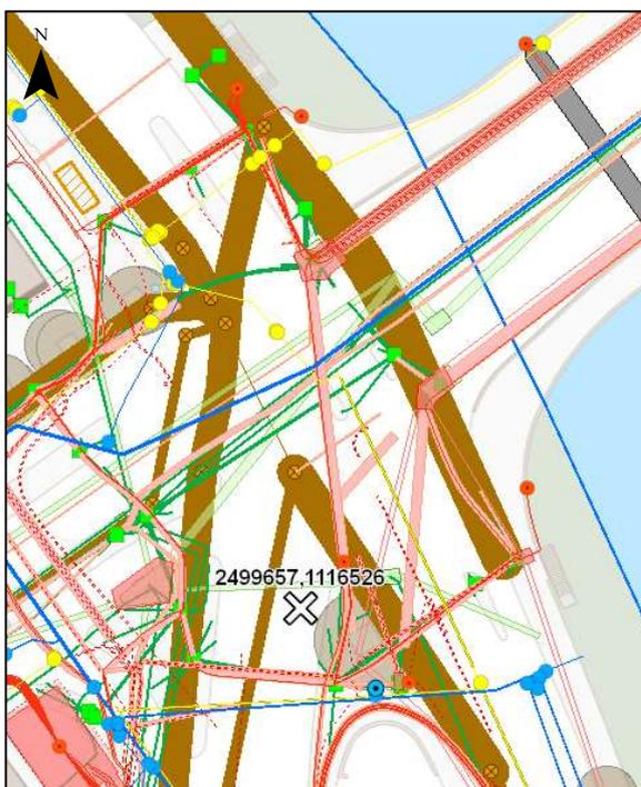
La situation à l'exutoire du pont des Acacias présente la même géométrie dans les deux solutions, seuls les diamètres varient. L'emplacement de la chambre au changement de trajectoire du collecteur, avant de se brancher dans l'ovoïde 2100/2500, est déterminé en fonction de l'encombrement du sous-sol où se croisent de nombreux services, voir Figure 23. L'emplacement des nouvelles chambres devra également faire l'objet d'une vérification vis-à-vis des autres réseaux.
