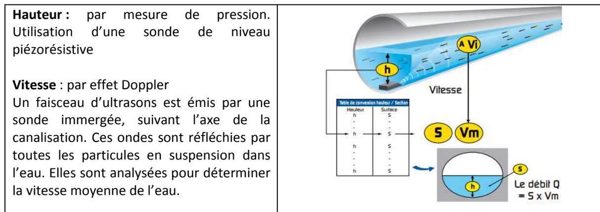
Figure 22 - Principe DOPPLER issu de la documentation HYDREKA
