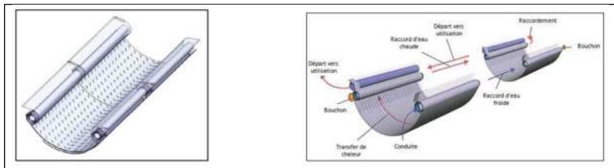
Figure 10 – Echangeur à plaques sur mesure (Source : SUEZ)
