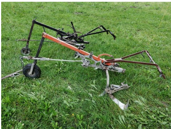
Image 5 : lames inter-ceps type Terraflex (prestataire 2).
