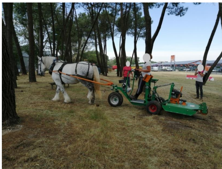
Image 11 : attelage à meneur porté Vitiméca, équipé d'une tondeuse.
