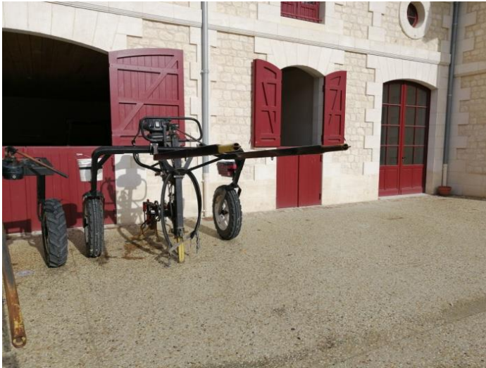
Image 9 : attelage porte-outils polyvalent, à meneur porté assis, conçu par l'exploitant 2.
