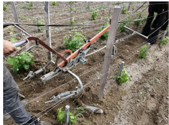
Image 16 et 17 : lames intercepts type Terraflex utilisées en terre sableuse (prestataire 2).
