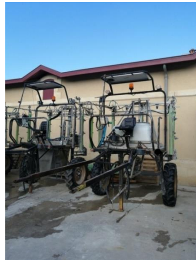
Image 10 : attelage pulvérisateur conçu par l'exploitant 2.
