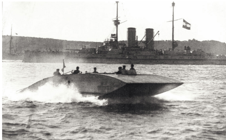
La vedette marine sur coussin d'air construite par Dagobert Müller von Thomamühl. © Visionaer/DR
