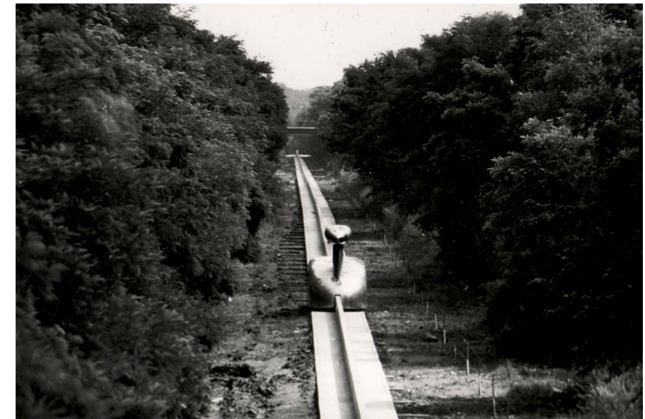
Aérotrain expérimental 01, échelle un demi, voie d'essai entre Gometz-la-Ville et Limours. © Association AJB
