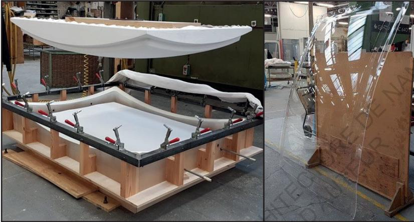
Ces baies neuves sont alors fabriquées en PMMA coulé incolore, ces plaques planes de 6mm d'épaisseur sont thermoformées entre deux moules (un mâle et un femelle). Alors pourquoi ne pas faire la même chose pour l'écrin, mais au lieu de prendre du PMMA translucide, on en prendrait du coloré ?
